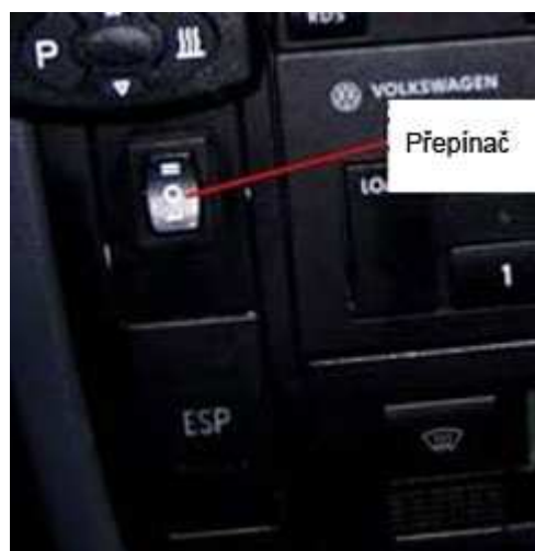
Obrázek 46: Umístění přepínače v záslepce tlačítka
