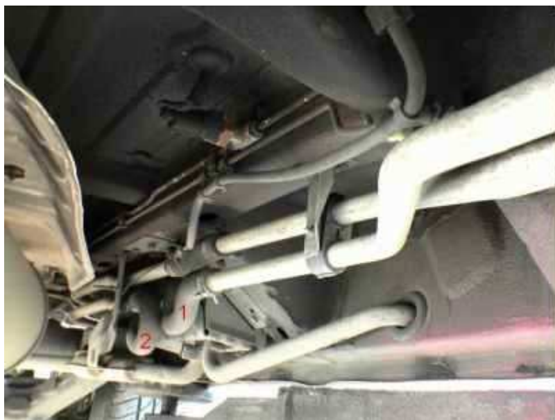
Obrázek 10: Přívod a odvod vody Bufíku, který je potřeba propojit
