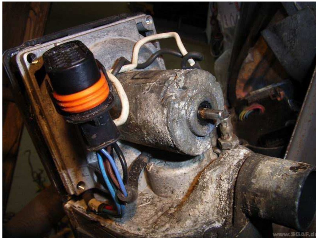
Obrázek 5: Plášť dmýchadla po vniknutí slané vody pod kryt Bufíku
