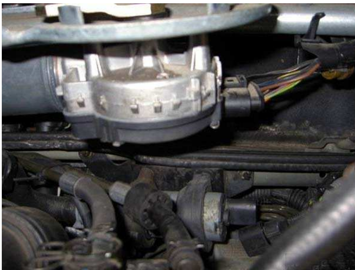
Obrázek 61: Doplnovací čerpadlo – umístění v motorovém prostoru
