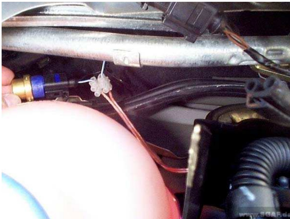
Obrázek 53: Snímač teploty: připojení k přívodnímu kabelu (snímek je pouze ilustrační – zapojení je jiné)
