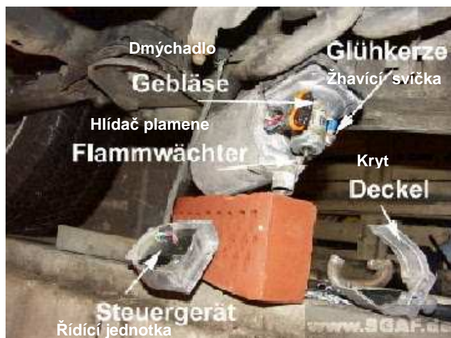
Obrázek 23: Částečně rozdělaný Bufík – popis částí
