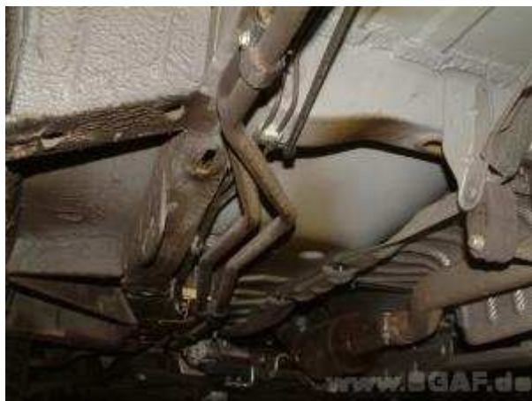
Obrázek 57: Přívodní potrubí chladící kapaliny k Bufíku
