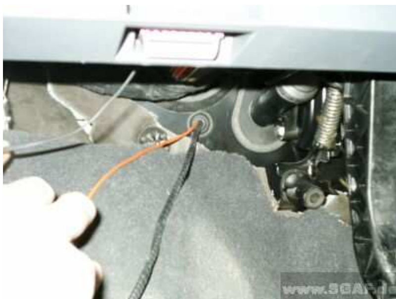
Obrázek 52: Záslepka v kabině vozidla pro vedení kabelu
