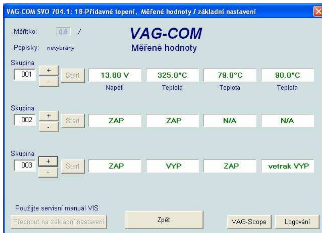
Obrázek 34: Hodnoty 3 – provoz na plný výkon (svíčka nežhaví – palivo zapnuto)
