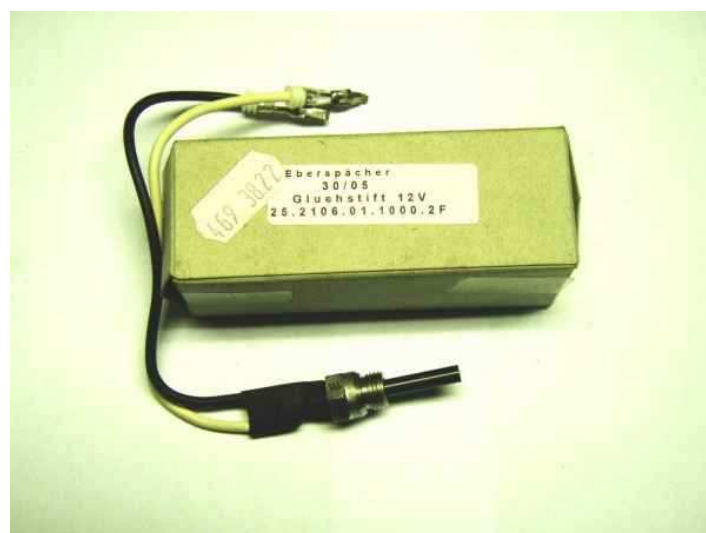
Obrázek 38: Žhavicí svíčka keramická (žhavicí kolík)
