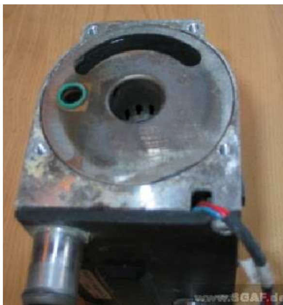
Obrázek 16: Sada hořáku s hubicí hořáku (střed) průchodka pro sítko (nalevo) výfuk (nahore)
