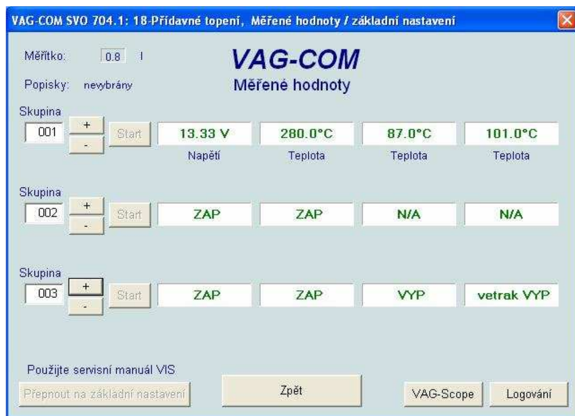
Obrázek 35: Hodnoty 4 – ukončování běhu Bufíku (svíčka žhaví – palivo vypnuto)
