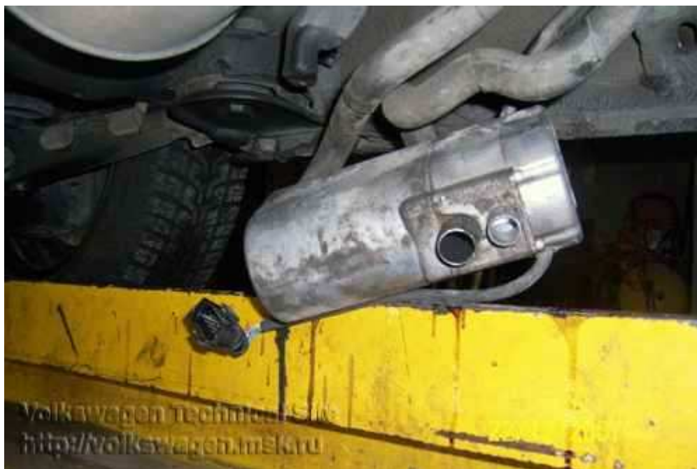
Obrázek 7: Bufík s odpojenou elektroinstalací vysící na hadicích vody
