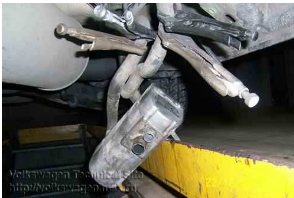
Obrázek 8: Zajištění hadic proti úniku chladící kapaliny
