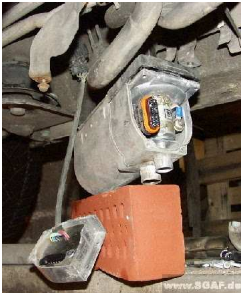
Obrázek 22: Odmontovaná řídicí jednotka a podložení Bufíku
