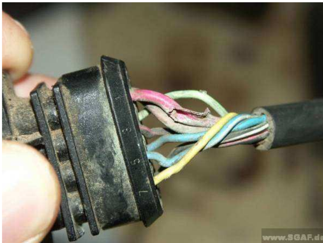
Obrázek 6: Přetržený vodič v elektrickém svazku
