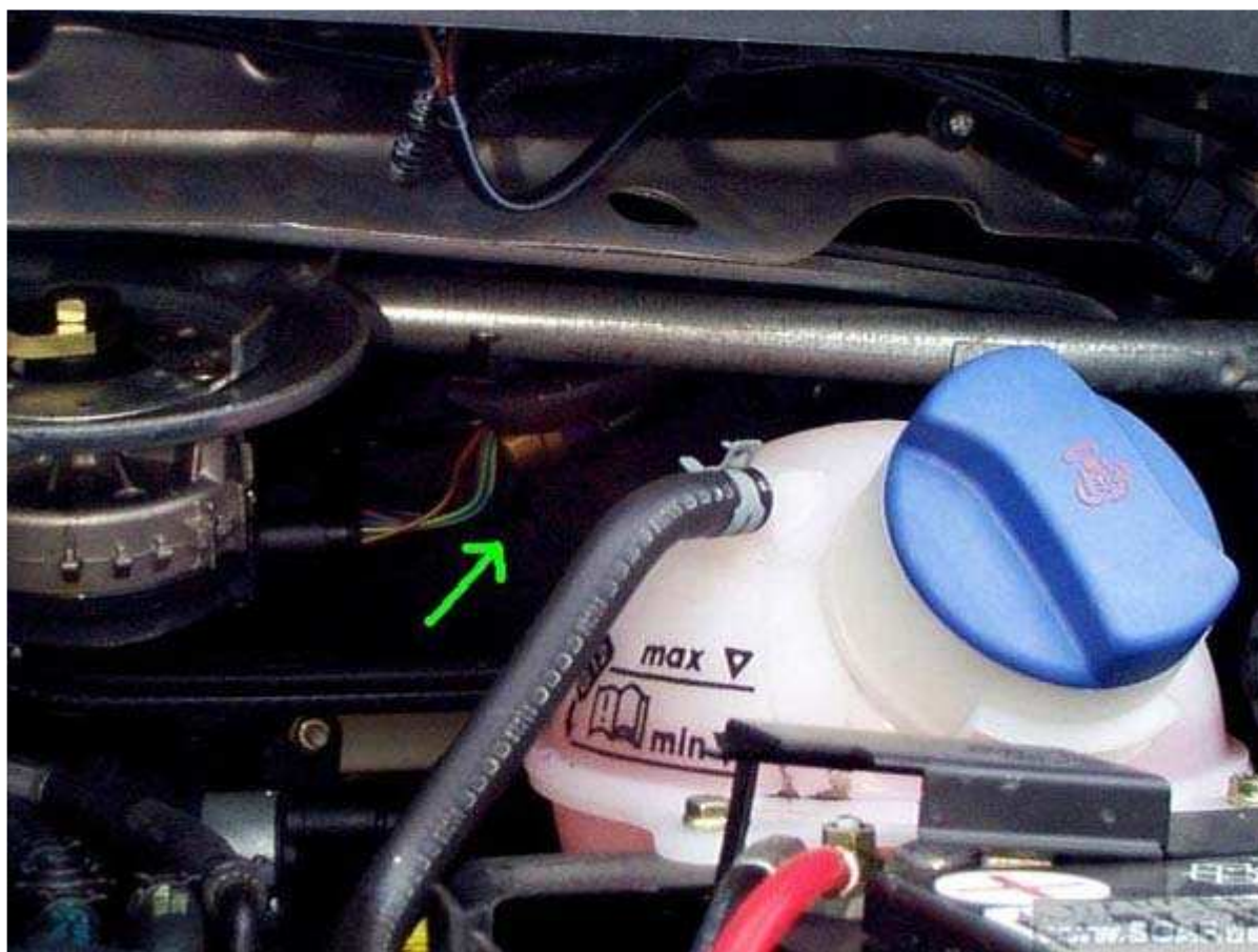
Obrázek 51: Umístění snímače teploty
