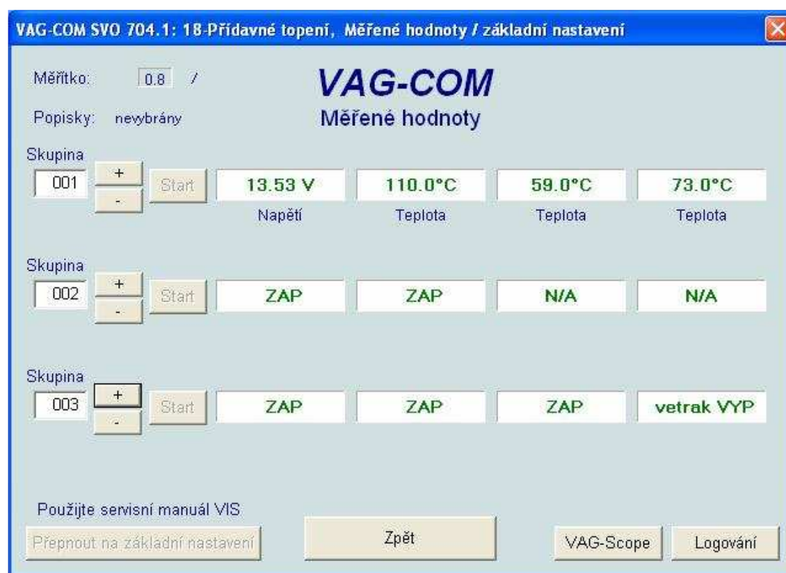
Obrázek 33: Hodnoty 2 – nabíhá hoření (svíčka žhaví- palivo zapnuto)
