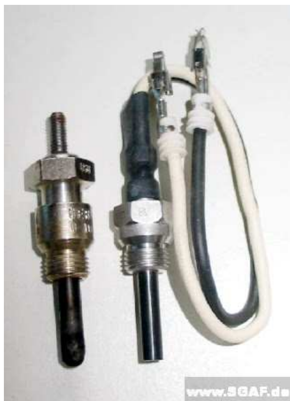
Obrázek 24: keramická žhavicí svíčka (vpravo) ve srovnání s kovovou žhavicí svíčkou
